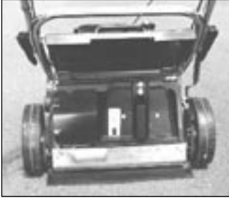
Abb. 1. Einbau des Mulchzusatzteils (Modelle 35m, 75m)
